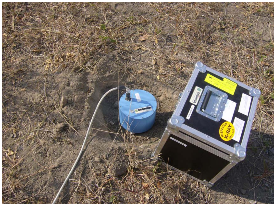
Figura 2. Arriba: Registrador Taurus en configuración. Abajo: Disposición óptima del sensor Lennartz de 5s para efectuar medidas de ruido sísmico ambiental.
