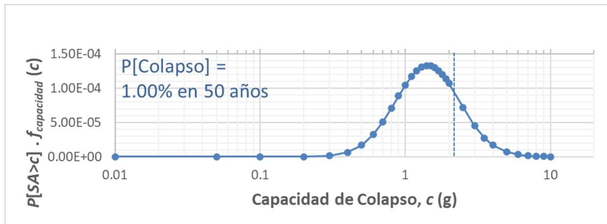
La metodología se basa en un proceso inverso iterativo en donde el resultado de la integral del riesgo es la probabilidad a colapso meta (fijo) y se deberá encontrar el correspondiente  $S_{MT}^*$  producto de las variaciones de las funciones de densidad de probabilidad (recordando que  $S_{MT}^*$  es una variable para su cálculo) y la correspondiente curva de amenaza (la cual no cambia).
