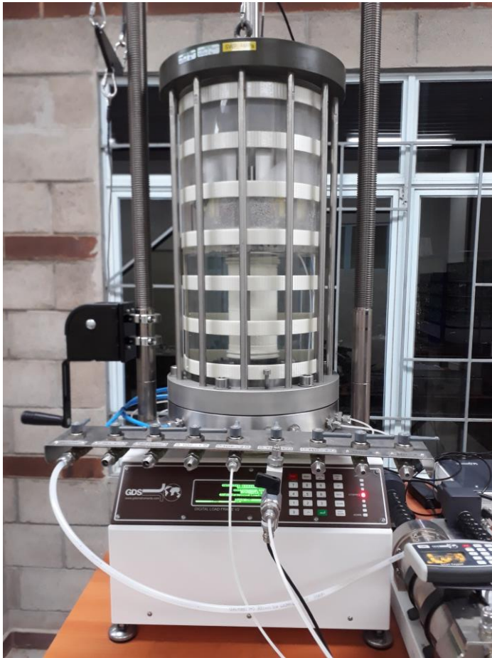
Ensayo piloto efectuado en muestra limo arenosa reconstituida
