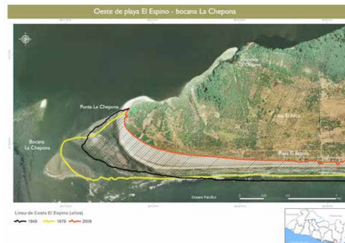
Figura 116. Posición de la línea de vegetación consolidada en el extremo oeste de la playa El Espino en fotografía PACAP. Fuente: Elaboración propia MARN
