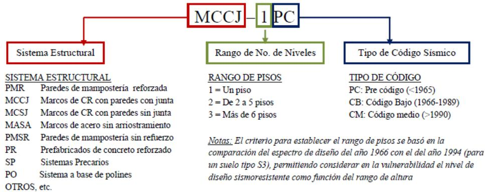
**Figura 5: Tipología de tipos de construcción de CAPRA.**
