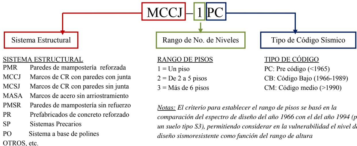
**Figura 3.3: Codificación básica de tipologías constructivas.**
